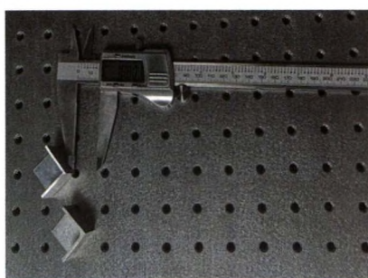
(a) 距离分辨率测量实物图
