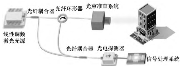
图 1 调频连续波激光雷达系统图
